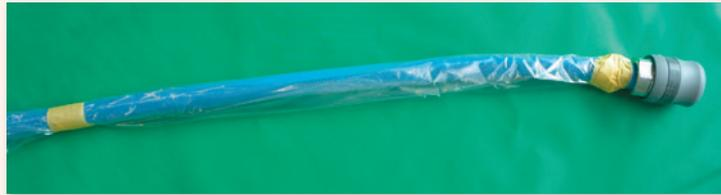
その後チューブの端部をマスキングテープで押さえる、好みて任意の箇所をテープで押さえても結構です
