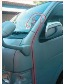
◀塗装作業に支障の無いサッシのウエーラストリップ部分等からココネートチューブを車外に出し、空気を吹き込む
