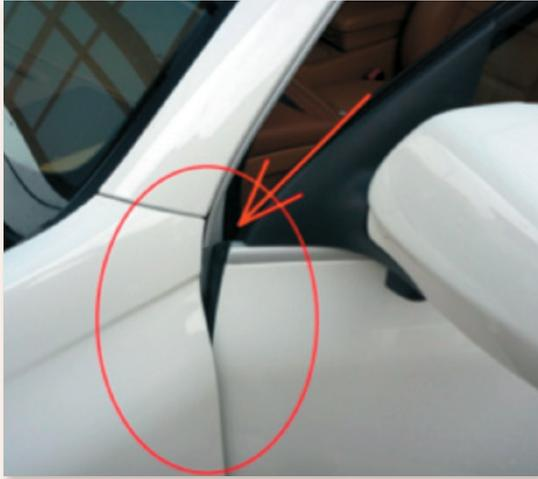
③切断したココネットチューブの内側にパテペラを差し込みフロントドア前側とウエザーストリップの間に差し込む(ココネットチューブの中は車種により適切に切断して下さい)
