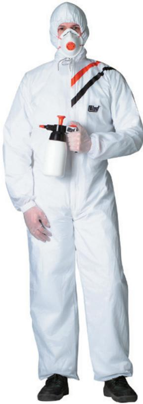
塗装ゴミの発生源の30%は塗装作業者とされます。スプレーヤーオーバーオールはゴミの発生原因を追及した結果この形状に成りました。前側の飾り(刺繍・ポケット・折り返し)の廃止、前側のシワ・タルミの排除、袖口・裾の引き締め、溶剤の吹き返しに耐える丈夫なゴムの使用、フケ・毛髪の脱落を止めるフードの採用、後ろ側2ヶ所に通気マドとタックラグ収納用にポケットを一カ所採用(タックラグは直に入れないでください)250gの軽量仕上げ、作業ツナギの上から着てもマトワリツキが少なく、又肌に直接触れる部分の快適さも考慮してあります。
