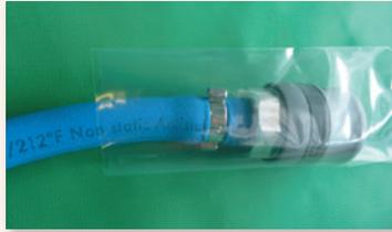
塗料ミストで汚れたココネートチューブの取り外しには【A005マグネットカッター】を御使用下さい
