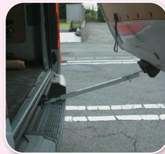
ドアに固定するリング部分は従来の製品は鉄丸棒を曲げ加工して溶接仕上げでしたが新型はレーザー加工機による無垢材からの切り抜きとし強度と精度を向上しました
