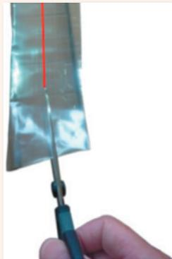
※ココネットチューブの内面はコロナ処理をしていません、裏表を間違えて使用しますと塗料剥離トラブルを起こしますのでご注意ください(表面の艶の少ない方が塗装に適したコロナ処理面です)
