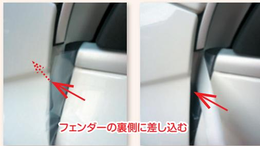
⑤ドアを閉じてパテペラを使いココネットチューブの差し込み具合を塗装し易いように整える
